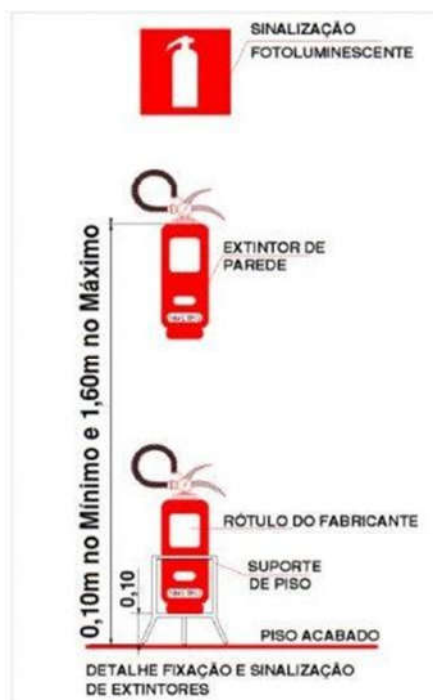
Fig. 02 – Detalhes fixação extintores
